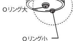
4 新しい浄水フィルター(底面) 2ヶ所にOリング装着されている事を確認します。取付位置をよく確かめ、浄水フィルターをしっかりと差込みます。上からホルダーをかけ、回して固定します。
