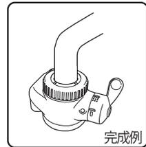
❗ ネジ部分を取り付ける際、ネジ径、ネジピッチ(ネジ山間隔)が合っていない場合、取り付け部のネジが破損する事があります。ネジ径、ネジピッチは正しくご確認ください。
