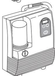
2 ホルダーのツマミを左に回し、浄水フィルターを上引き上げると浄水フィルターが外れます。
